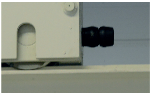
► Notstopp-Dämpfung an einem Portalkran
