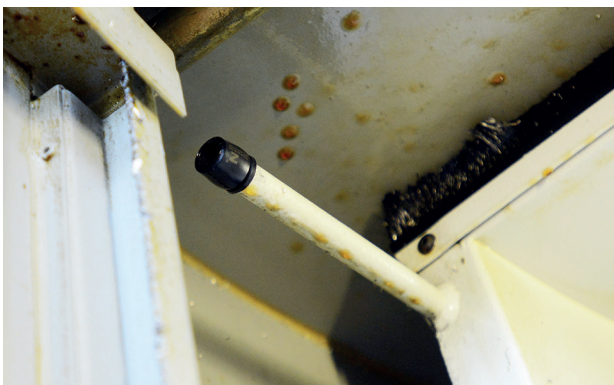
► Dämpfung der Maschinentür in einem Bearbeitungszentrum
