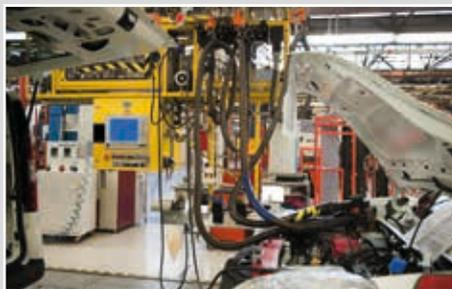
Wachsförderschläuche, Heizleistung 60-120 W/m, Beheizung mit minimierten Toleranzen zur Gewährleistung einer extrem gleichmäßigen Konsistenz
