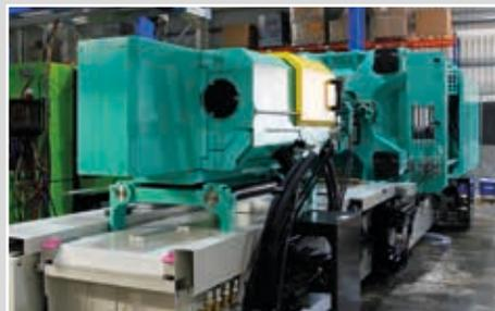
CNC-gesteuerte Spritzguss-Produktionsmaschine. Temperierung von Kunststoff und Kleber im Heizschlauch bei Herstellung von Gehäuseteilen (PA, TPE, EVA)
