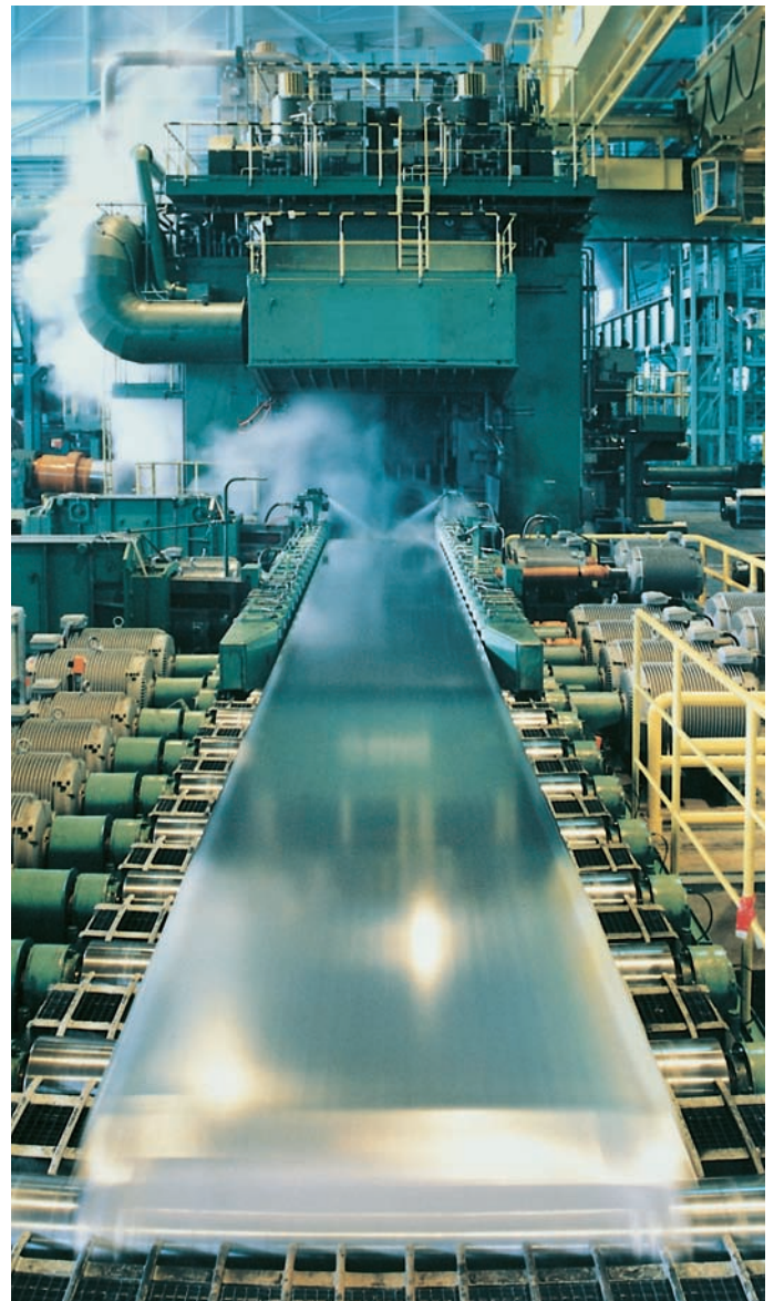
Warmwalzgerüst für Aluminiumbänder
