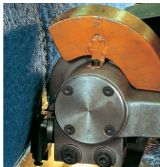
Der Abschervorgang an einer Walzenbürste
