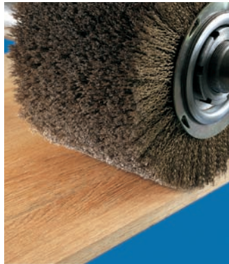
Erzielen einer Struktur auf Harthölzern durch Walzenbürsten mit Drahtbesatz
