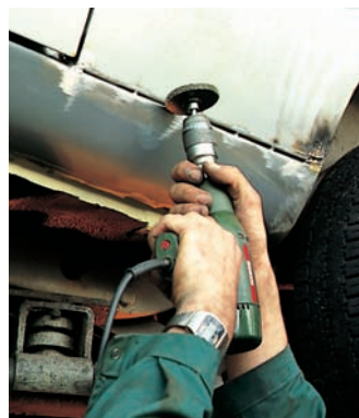
Schweißnahtbearbeitung mit einer Delta Schaftgrundbürste.
