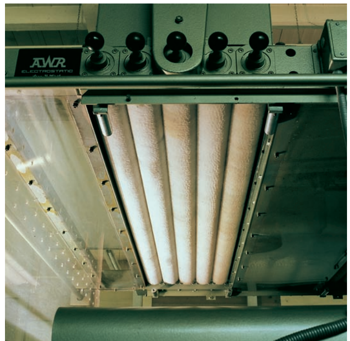
Walzenbürsten verteilen die Flockmasse in Textil-Beflockungsmaschinen
