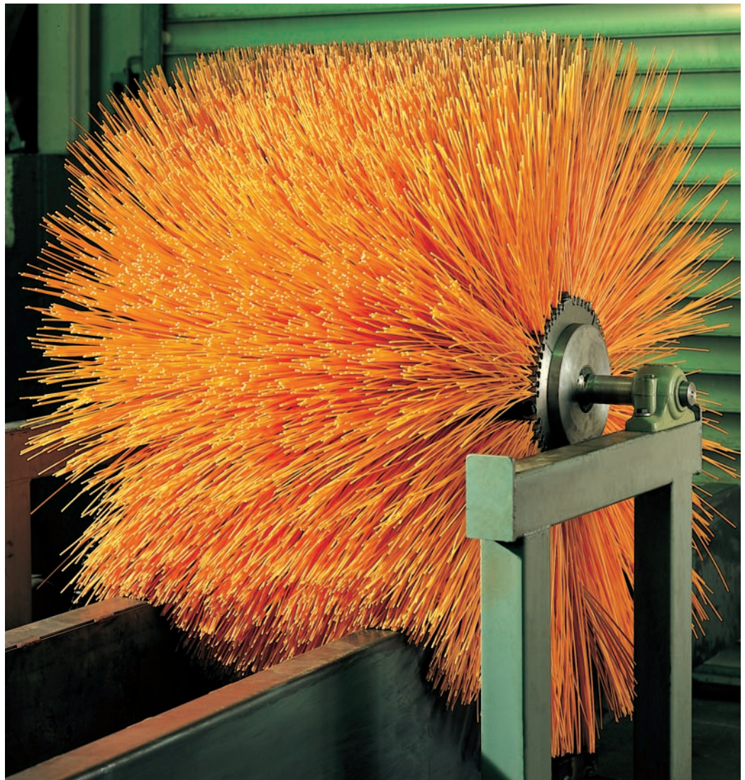
Entfernen der Strahlmittel auf Profilen in Durchlauf-Schleuderstrahlanlagen
