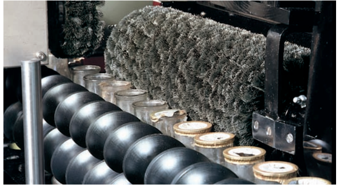
Bürstentechnik im Recycling: z. B. beim Abtrennen der Deckel von Aludosen.
