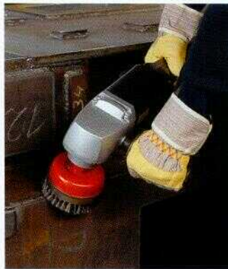
Topfbürste und Winkelschleifer im Einsatz.
