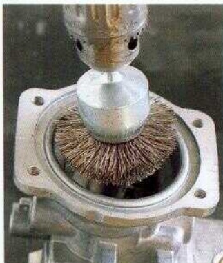
Innenbearbeitung eines Ventilkörpers mit einer Pinselbürste Type G.
