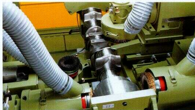
Topfbürsten werden höchsten Qualitätsansprüchen gerecht – hier beim Entgraten einer Kurbelwelle.
