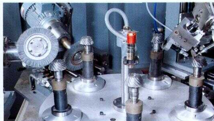
Eine Rundtisch-Entgratmaschine mit zwei Vorschleif- und zwei Bürstenstationen.
