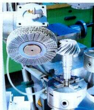
Eine Alpha-Einzelscheibenbürste bearbeitet ein Kegelrad aus Stahl.
