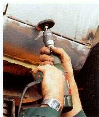
Schweißnahtbearbeitung mit einer Delta Schafrundbürste.
