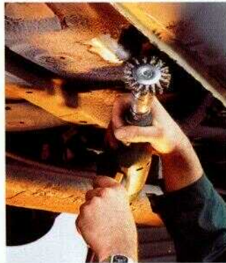
Entfernen von Unterbodenschutz mit einer Ultra Schafrundbürste.
