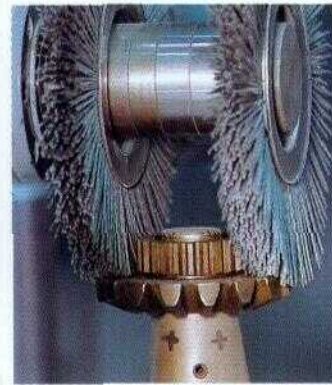
Präzises Entgraten von Außenkanten an einem Wellenrad aus Stahl.
