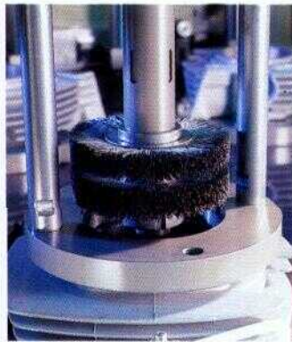
Zwei Alpha Einzelscheiben-Bürsten honen einen Zylinderkopf.
