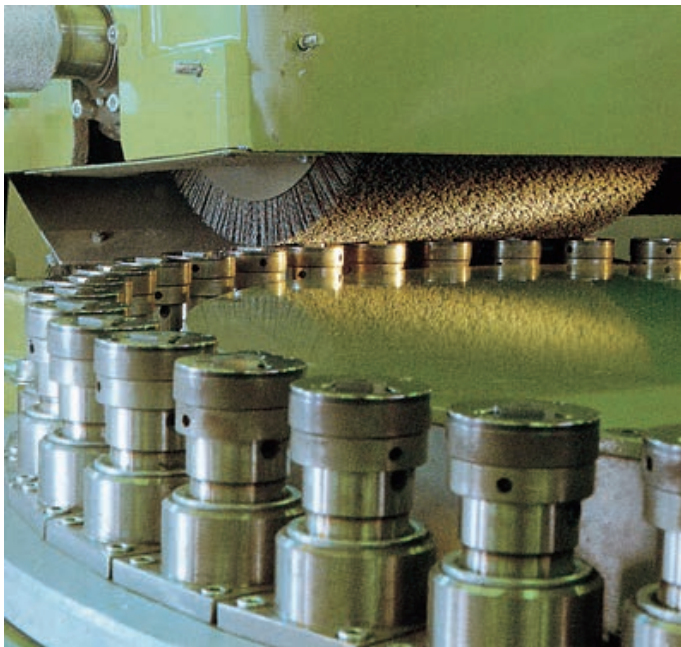
Eine Walzenbürste mit ANS-Besatz entgratet diese Hartmetall-Wendepplatten auf einer Rundtisch-Entgratmaschine.
