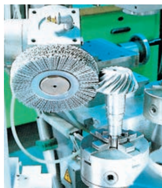
Eine Alpha-Einzelscheibenbürste bearbeitet ein Kegelrad aus Stahl.
