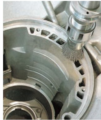
Stirnflächen-Entgraten an einem Getriegehäuse mit einer Alpha Pinselbürste.
