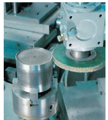
Entzundern eines Filtergehäuses mit kunststoffgebundenen Delta Einzelscheiben-Bürste.
