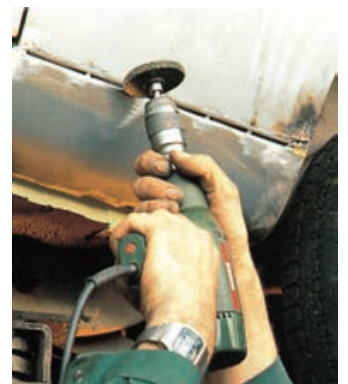
Schweißnahtbearbeitung mit einer Delta Schafrundbürste.
