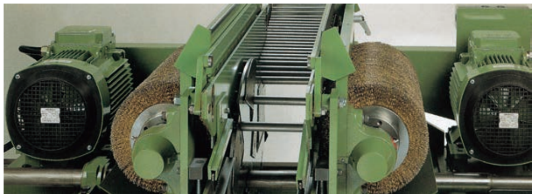
Entgratautomat für Rohre, Profile und Stangenmaterial von 20–20 000 mm Länge.
