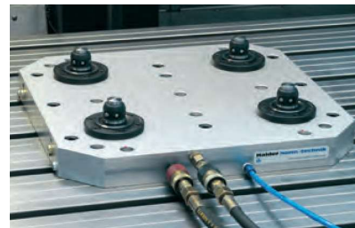
Masa mașinii placă de bază cu 4 elemente de tragere în interior
