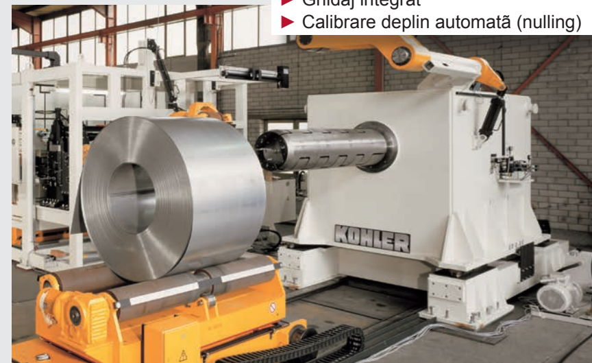
Linie de tăiere longitudinală (Sursă: Kohler Maschinenbau)
