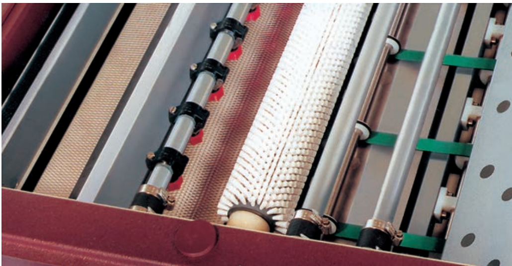
Walzenbürsten sind in Offsetdruckplatten-Entwicklungsmaschinen unentbehrlich.
