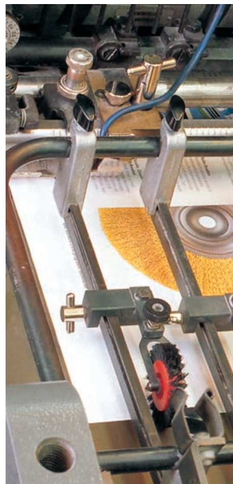
Rundbürsten sorgen als Bogenanleger an Bogenoffsetdruckmaschinen für den einwandfreien Papiereinzug.
