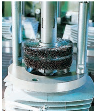
Hier entgratet eine Alpha-Einzelscheibenbürste einen Zylinderkopf.
