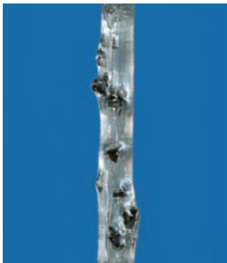
Mikroskopische Abbildung einer ANDERLON-Schleifbürste mit Silicium-Carbid-Korn.
