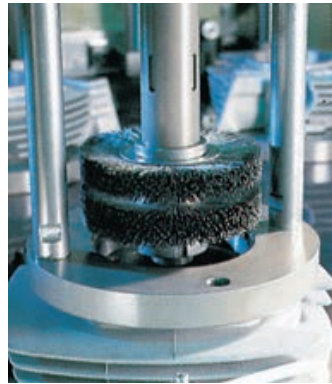
Zwei Alpha Einzel-scheiben-Bürsten honen einen Zylinderkopf.
