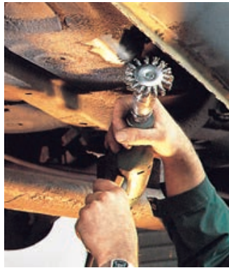
Entfernen von Unterbodenschutz mit einer Ultra Schafrundbürste.
