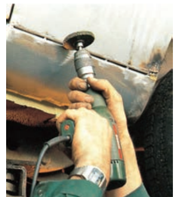
Schweißnahtbearbeitung mit einer Delta Schafrundbürste.
